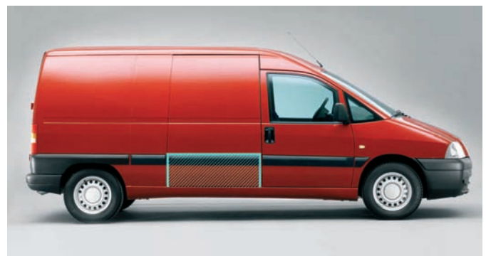
Costado susceptible de sustitución parcial
